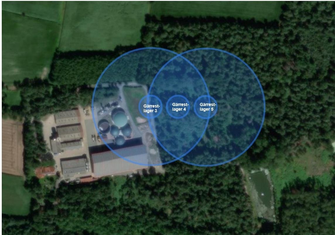
Abbildung 7: Ausbreitung der toxischen Atmosphäre oberhalb AEGL-2 Wert ausgehend eines der Gärrestläger 3 oder 5 – schemenhaft Windrichtungsunabhängig /Quelle: calcmaps 2025/
